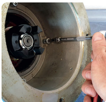
Om de bereikbaarheid te vergemakkelijken, verwijder eerst de behuizing.
