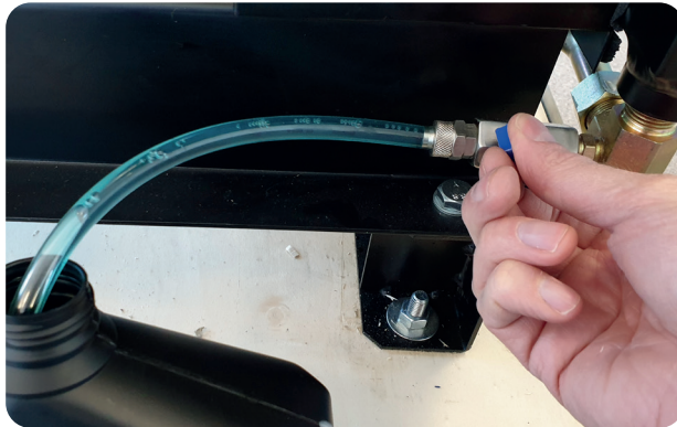
Aftappunt rechts (oliekoeler). Zorg voor een reservoir met voldoende inhoud. Zie voor olie inhoud van de compressor pagina 22.
