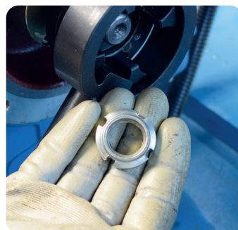
Om de kop te verwijderen dient u eerst de borgmoer (kroonmoer) te verwijderen. Hiervoor is een speciale dop nodig (KM4) en borggereedschap. Draai vervolgens de moer los en verwijder deze.
