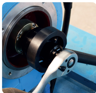
Om de kop te verwijderen dient u eerst de borgmoer (kroonmoer) te verwijderen. Hiervoor is een speciale dop nodig (KM4) en borggereedschap. Draai vervolgens de moer los en verwijder deze.
