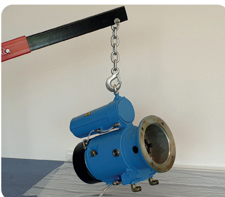
Als het restant olie uit het compressorblok gelopen is kunt u deze (bijvoorkeur met lift/takel) op de werkbank plaatsen.
