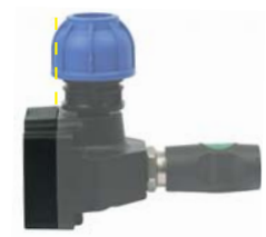
Model R241: bij het gebruik van Ø25 koppelingen zal de wartel uitsteken. Gebruik dan een afstandhouder.
